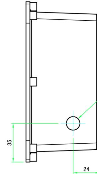
M4インサートナット(ポールマウントWGMB-1取付用)
