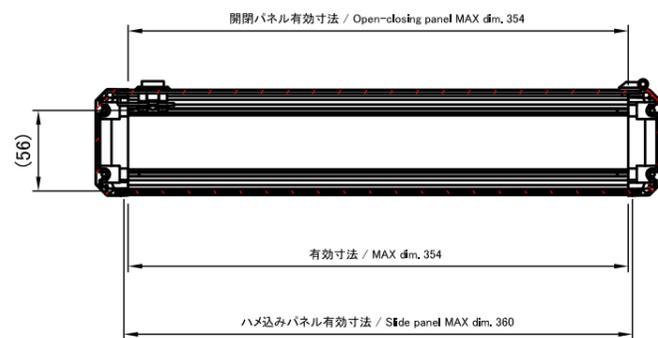
C: フレーム拡大図 / Frame cross-section
