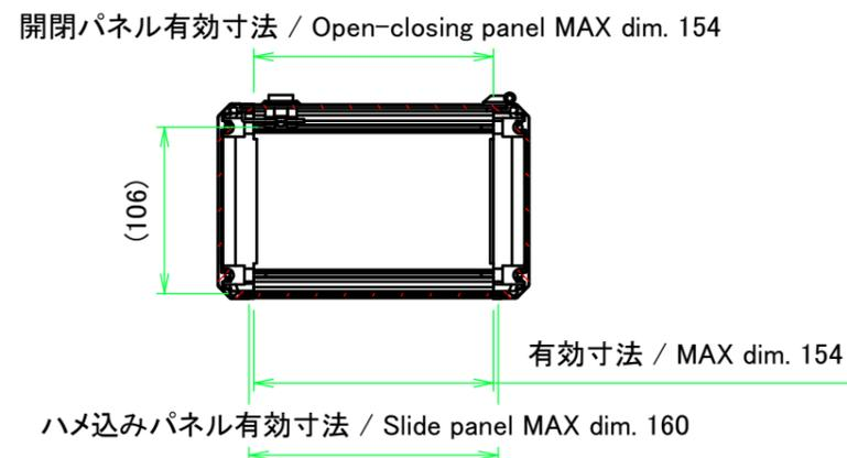
C: フレーム拡大図 / Frame cross-section
